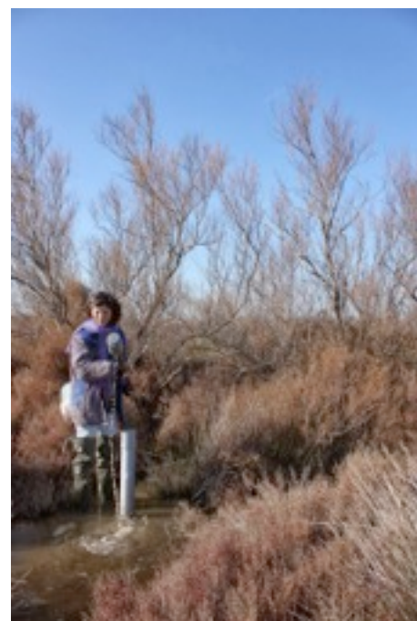
Suivi de la nappe à l'aide d'un piézomètre
